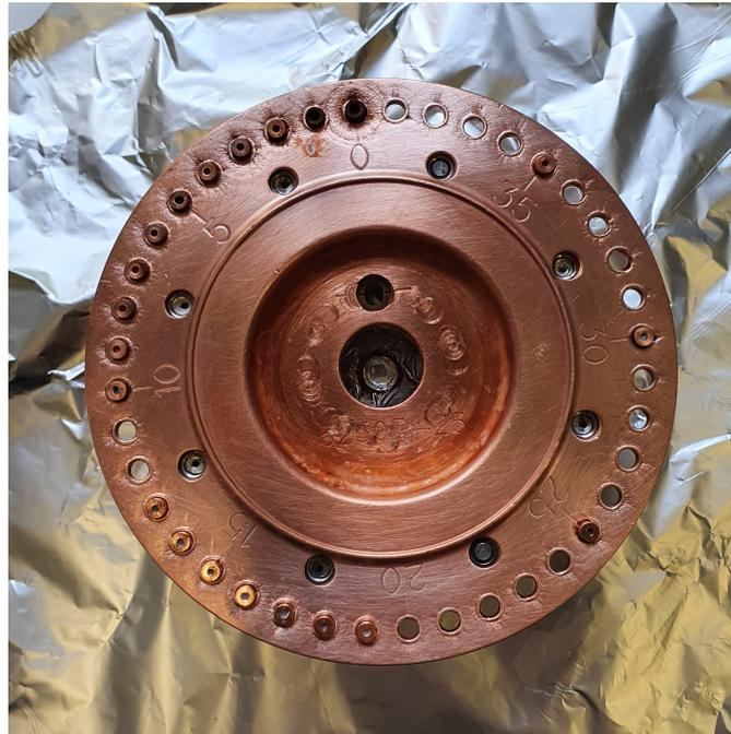
Abbildung 3.1.: Kupfer-Probenrad mit den Standards (5, 10, 25, 30, 35) und den zu untersuchenden Kathoden (13-19). An den Stellen 0-4 und 6-9 befinden sich Kathoden, welche nicht direkt Teil dieses Experiments sind.
