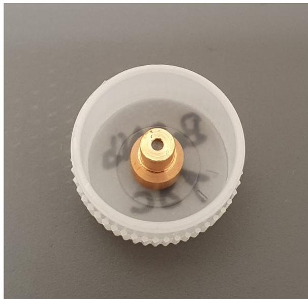
Abbildung 4.1.: Kupfer-Kathode, in welches das Probenmaterial (Berylliumoxid im Verhältnis 1:8 mit Niob) gepresst ist.
